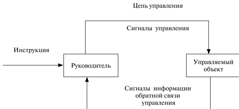
Рис. 1.5. Схема неавтоматического управления объектом
